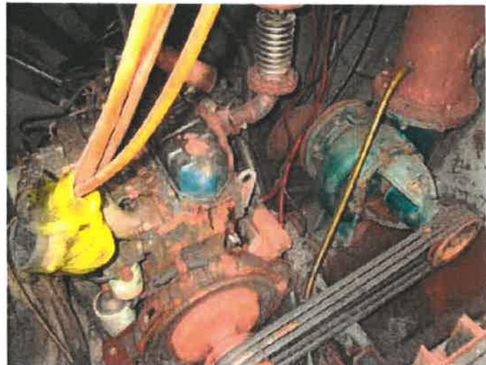
(15) 该船柴油机驱动冲水泵
